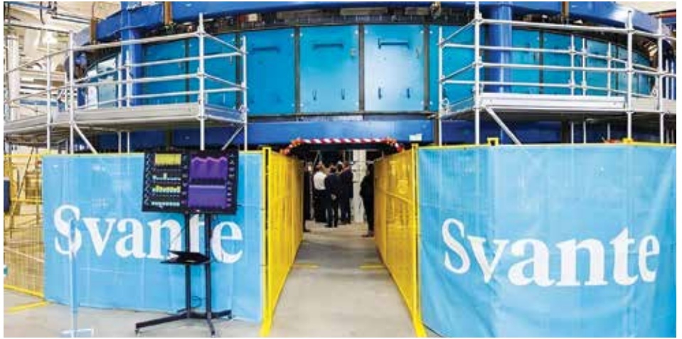
شركة "سفانتي"، أنشأت مصنفا في مدينة "فانكوفر" الكندية، تستخدم تقنية مبتكرة يطلق عليها "المُرشحات"، وهي عبارة عن طبقات مُهيكلّة لامتصاص الكربون
