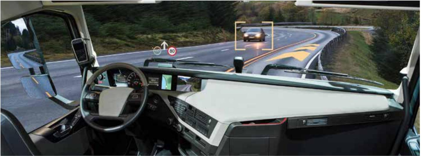
ومن التقنيات المهمة المستخدمة، تقنية الليدار Lidar، وهي تقنية استشعار تستخدم أشعة الليزر لقياس المسافات وإنشاء خرائط ثلاثية الأبعاد عالية الدقة لمحيط السيارة للكشف الدقيق عن الأشياء، من خلال إصدار نبضات ليزر وقياس الوقت، ويتيح ذلك اكتشاف وتتبع المشاة وراكبي الدراجات والمركبات وأي عوائق أخرى.
